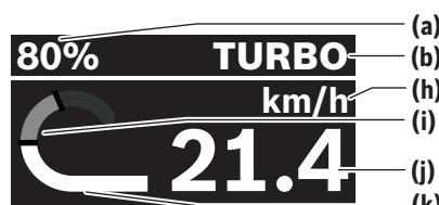
**(a)** Nivelul de încărcare a acumulatorului eBike (configurabil)
